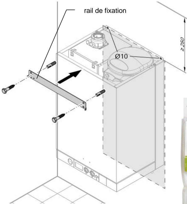
On souhaite fixer un rail de fixation afin de maintenir une chaudière de 60 kg au mur.
