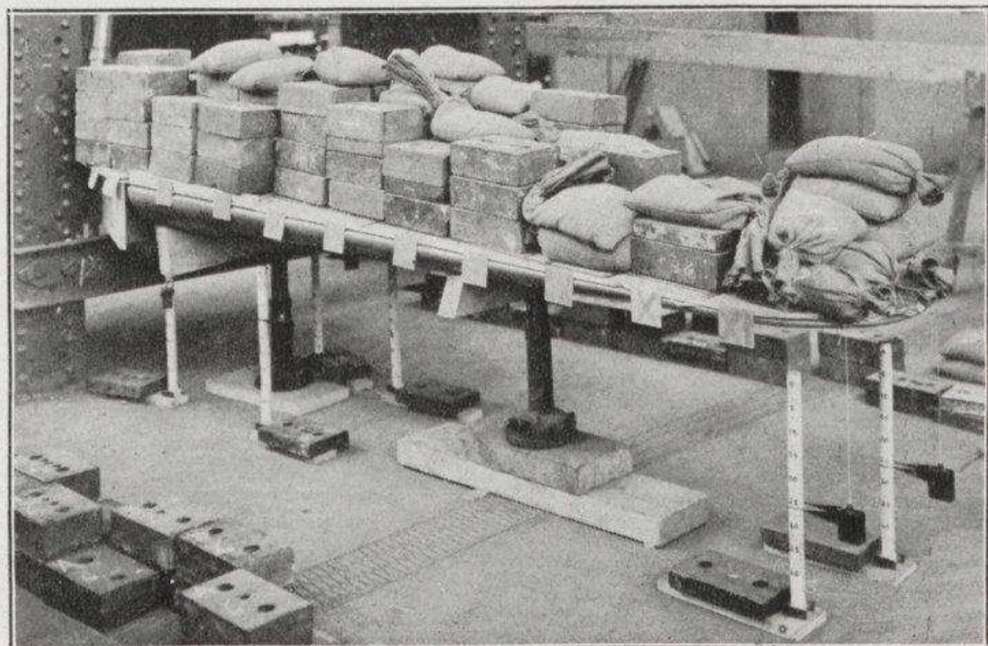
Essai d'une aile de POTEZ 533 : coefficient probable de rupture, 7.
