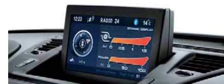
Le Radio NAV affiche la pression du turbocompresseur et la puissance en %.
