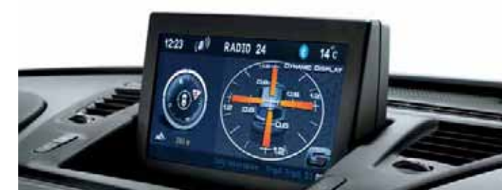
Le Radio NAV affiche également la valeur d'accélération (longitudinale et latérale) à laquelle la voiture est soumise.
