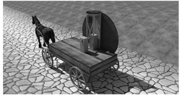
Une roue porte sur le sol et en tournant entraîne un système de pignons et plateaux pour aboutir à un tambour comportant des cases. Chacune des cases contient une bille ou un caillou. A une position donnée, chaque case passe sur un trou qui laisse échapper une bille qui tombe dans un tiroir. À la fin de la mesure, le nombre de billes tombées du tiroir donne la distance parcourue.
