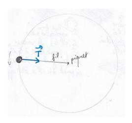
Le poids et la réaction normale s'annulent dans la mesure où le support est horizontal. Le bilan des forces, la somme des forces exercées est ici la tension  $\vec{T}$  du fil.
