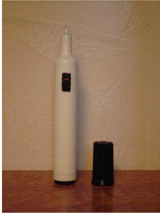
Le stylo infrarouge terminé, il ne reste plus qu'à le tester. On peut utiliser un appareil photo numérique ou une caméra pour se rendre compte si la diode fonctionne.
