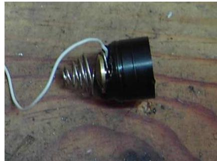
Percez le bouchon du feutre (expulsé à l'air comprimé) et y fixer le ressort de maintien de pile récupéré sur la télécommande. Souder sur le ressort un petit fil qui sera soudé directement à la borne négative de la diode. Le fil doit être suffisamment fin pour ne pas coincer la pile. Il passe par l'échancrure aménagée dans la pièce de 1 centime.
