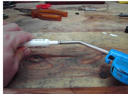
Ôtez la pointe du feutre avec une pince. Chassez le bouchon de fermeture à l'air comprimé.
