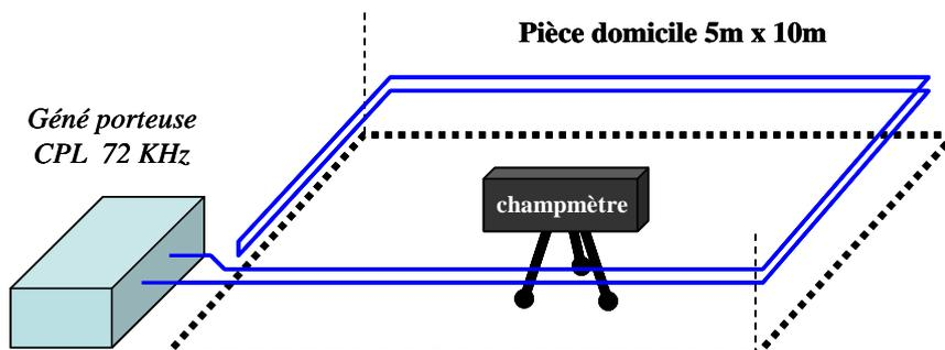
Ici, les fils de la boucle sont connectés afin que le courant injecté parcoure son aller et retour sur le même chemin physique, comme un CPL qui courrait dans les fils phase et neutre dans une même gaine électrique.
