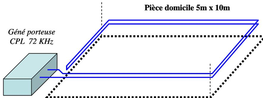
Ici, le courant CPL court sur l'aller et le retour le long de la même trajectoire en faisant demi-tour au point fermé, qui serait en réalité un appareil branché. On suppose que l'appareil branché laisse passer les hautes fréquences.
