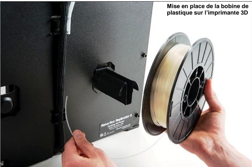
Mise en place de la bobine de plastique sur l'imprimante 3D
