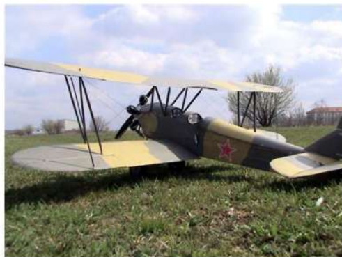
Polikarpov Po2 poids 1,3kg, moteur L3015 1000kv, accus 3S 2200mA, envergure 1300mm
