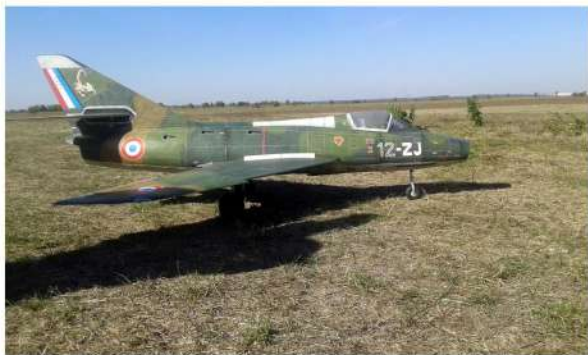
Dassault Super Mystère Poids 3,5kg, turbine EDF 90mm ; accus 5S 4000mA Longueur 2100mm envergure 1500mm
