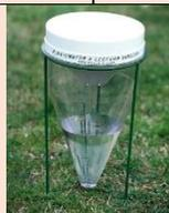
Cet appareil est un **pluviomètre** : il sert à mesurer la quantité de pluie tombée par cm<sup>2</sup>.
