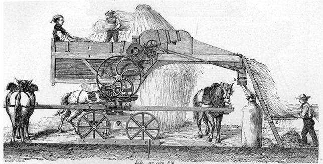
Fig. 349. — Batteuse Dancy à manège direct placé sous la batteuse.
