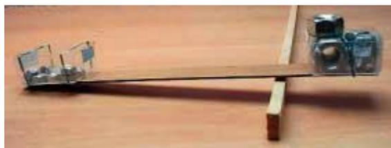
Si l'on rapproche le pivot de la charge, il devient alors possible de la soulever.
