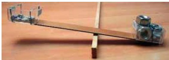
Dans cette configuration, la charge (cinq gros écrous dans la boîte de droite) ne peut pas être soulevée par la force due aux six petits écrous situés dans la boîte de gauche.
