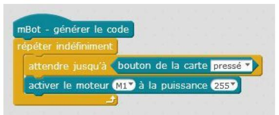
Le morceau de programme ci-dessus permet lorsque l'on appuie sur le bouton poussoir de la carte de mettre en marche le moteur 1 du robot à la vitesse maxi.
