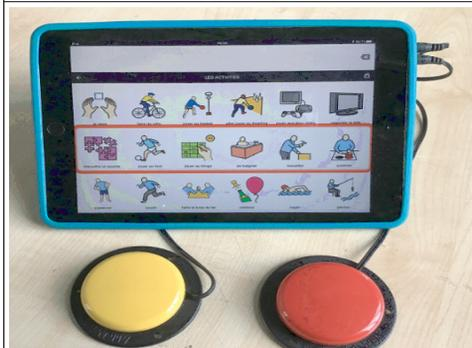
Branchement de deux contacteurs (défilement manuel sous IOS)
