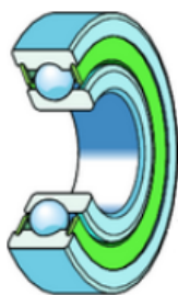
Schéma d'un roulement à billes écorché
