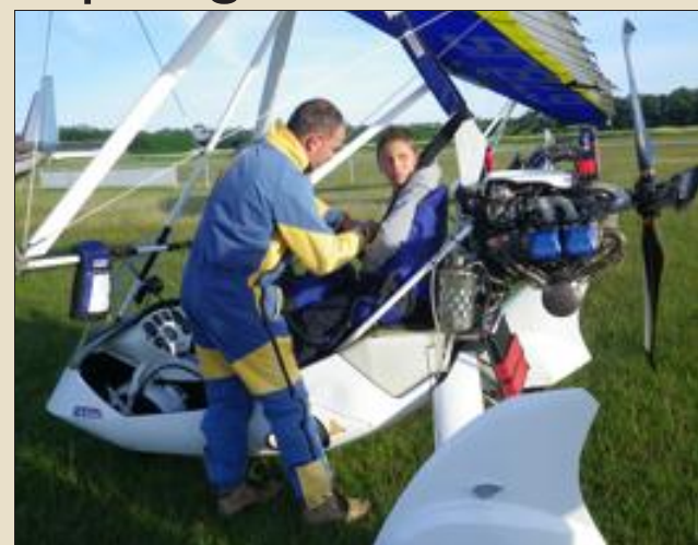
L'ULM pendulaire de l'instructeur de Batzdorf est doté d'un moteur d'une puissance de 60 chevaux.
