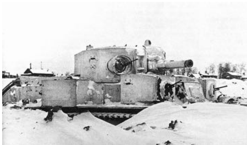
Un T-28 de la 42 e Armée en embuscade sur le Front de Léningrad, le 9 décembre 1941. Armé d'un canon L-10 long de 26 calibres doté d'une vitesse initiale de 555 m/s, ce T-28 a reçu un blindage additionnel. A l'instar des autres chars multi-tourelles, le T-28 souffrait d'un blindage relativement faible, d'une silhouette massive et d'une difficile coordination des différents armements du char.
