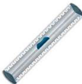
Le double décimètre est gradué en centimètres et en millimètres.
