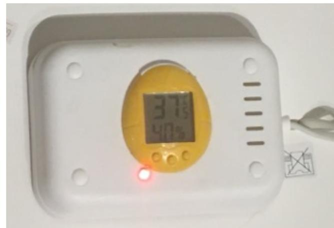
Le boîtier digital permet l'affichage de l'hygrométrie. Celle-ci se règle grâce au bac à eau moulé dans la partie basse de la couveuse.
