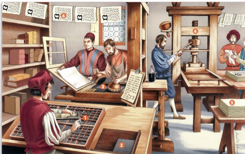
Les différentes étapes de fabrication d'un livre imprimé
