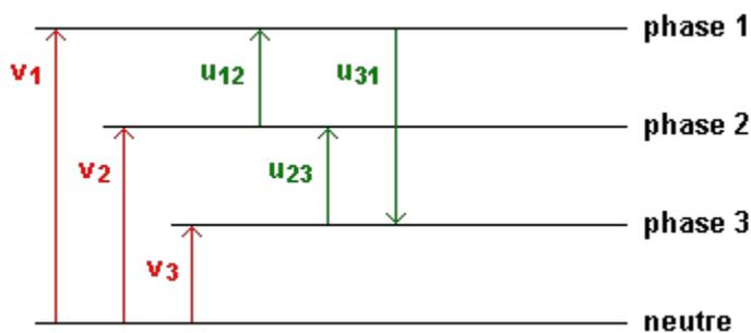
Les tensions  $V_1$ ,  $V_2$  et  $V_3$  sont appelées tensions .....
