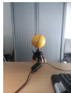
Figure 5-3: niveau de champ magnétique dans la bande de fréquences utilisée pour le CPL Linky Mesure sur un poste de travail, à 20 cm d'un bloc chargeur / alimentation d'ordinateur portable
