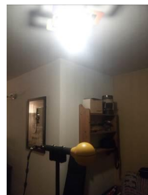
Figure 5-4: niveau de champ magnétique dans la bande de fréquences utilisée pour le CPL Linky Mesure dans un logement, sous une lampe à LED 13W (distance : 65 cm)
