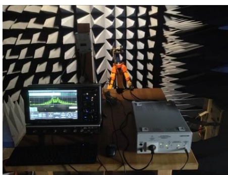
Figure 3-6: caractérisation des niveaux de sortie en tension des compteurs Linky prêtés par Enedis (norme EN 50065-1)
