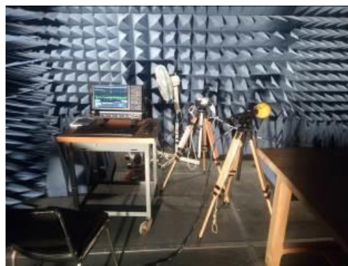
Figure 3-3 : mesures de champ magnétique et de courant électrique en amont et en aval d'un compteur Linky
