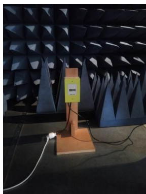
Figure 3-2 : compteur Linky et système de mesure du courant électrique
