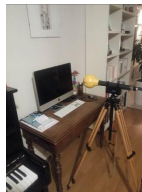
Figure 5-5: niveau de champ magnétique dans la bande de fréquences utilisée pour le CPL Linky Mesuré dans un logement, devant un écran plat d'ordinateur
