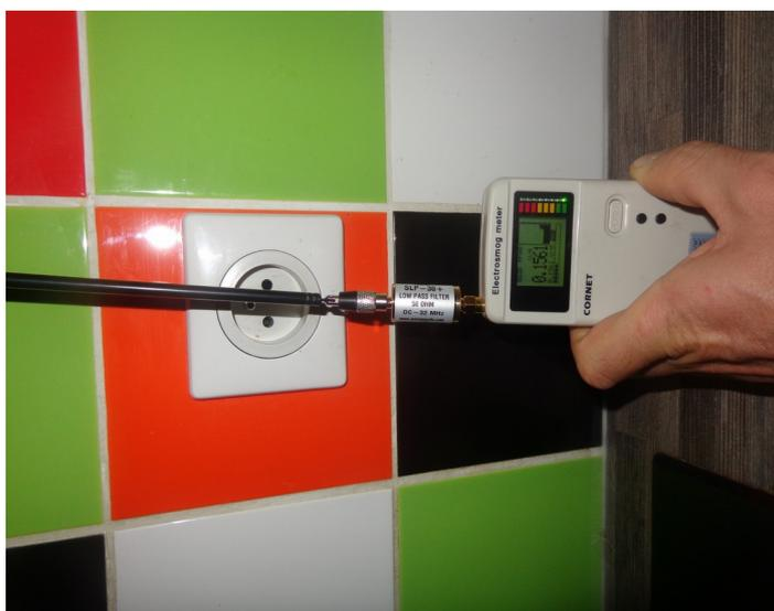
Pour mettre en évidence uniquement les rayonnements venant des fils de terre j'ai rajouté entre le cornet et son antenne un filtre prenant uniquement les fréquences entre 1 Mhz et 32 Mhz pour éviter de mesurer des émissions wifi, antenne relais radio FM...)
