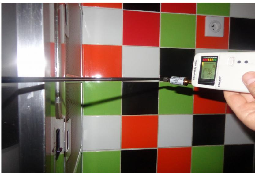
Remarque importante : j'ai mis en place entre l'appareil de mesure et l'antenne un filtre passe-bas (voir photo ci-dessus) laissant uniquement passer les fréquences de 1 Mhz à 32 Mhz et ceci afin de mesurer uniquement les fréquences injectée entre 1Mhez et 24 Mhz à l'aide du générateur de signux (donc filtrage des émissions wifi, antennes relais, radio FM..)
