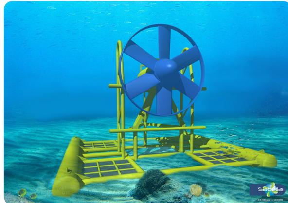
Les courants marins font tourner les **pales** de l'hélice qui entraînent une **turbine**. Ce mouvement est à son tour **transformé en électricité par l'alternateur**. Un câble relié au rivage ramène l'électricité produite jusqu'à la terre.
