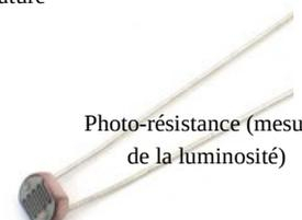
Photo-résistance (mesure de la luminosité)
