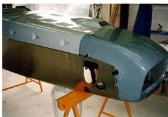
passionnés le reconforteront. Capot et ailes seront également livrées à du ponçage, de l'ajustage et du masticage. Un carrossier professionnel se chargera de détails de finition pour soulager Hervé dans son travail de titan.
