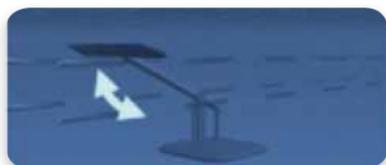
**3** Les hydrofoils, maintenus par un bras articulé, oscillent suivant la verticale sous l'effet d'une combinaison de forces de portance et de traînée.
