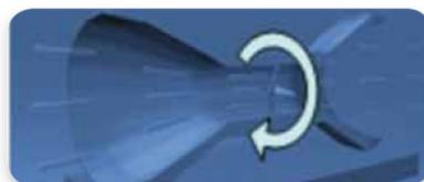
**4** Les hydroliennes qui exploitent « l'effet Venturi », c'est à dire l'accélération d'un fluide dans une conduite dont le diamètre se rétrécit
