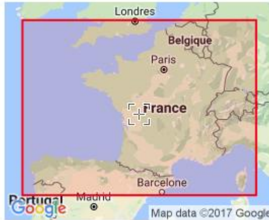
Figure 1 : Zone d'utilisation du système de Lambert 93
