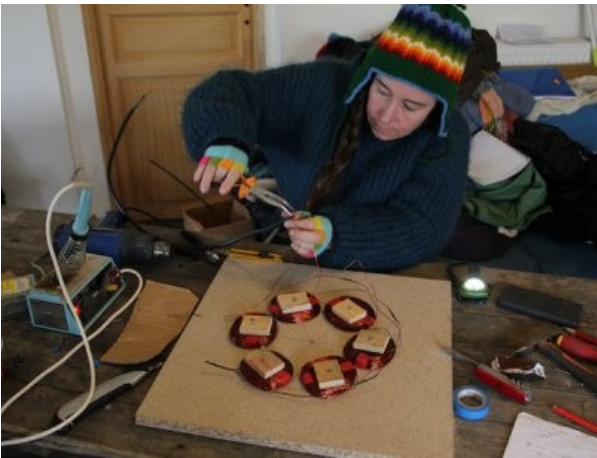
On enroule les bobines...
