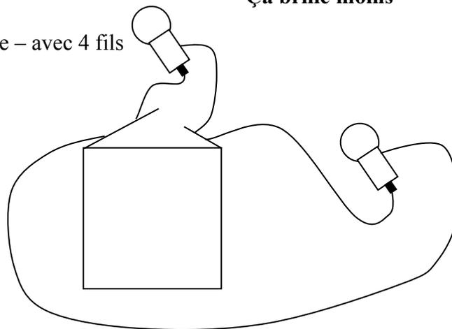
J'allume 2 ampoules avec la même pile – avec 2 fils
