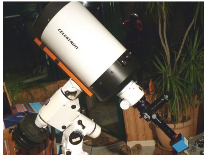
Figure 1 : présentation du montage utilisé pour les mesures. Pour la partie optique, on reconnaît le C8 avec un porte-oculaire additionnel, le flip-mirror, la barlow x 2 et la caméra CCD DMK41.
