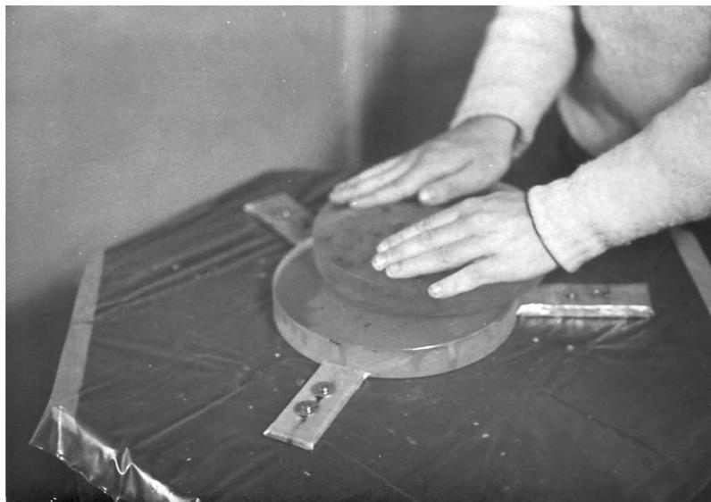
En moyenne ces courses ont pour longueur un tiers du diamètre des disques. Ceux-ci doivent donc être décalés d'un sixième de D en bout de course, soit 2 à 3 cm pour un 160 mm de diamètre et 3 à 4 cm pour un 210 mm.
