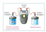
**a.** Dispositif ExAO permettant de mesurer, grâce à une sonde, la quantité de dioxygène
