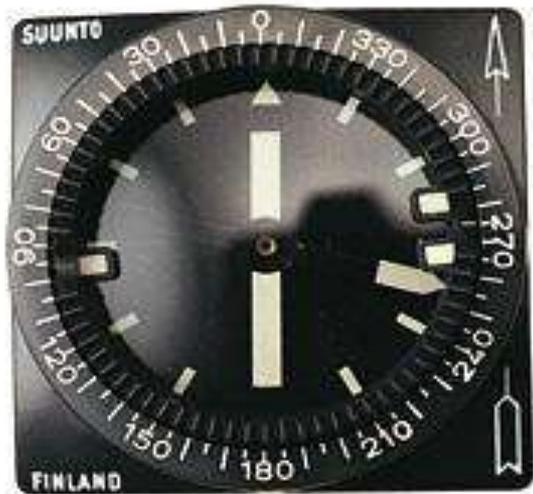
La boussole a une aiguille aimantée libre sur un axe vertical. La rose des vents est fixe.
