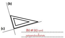
Pour tracer une droite perpendiculaire à une autre, on utilise une équerre.
