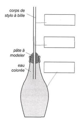
Wir führen 2 Experimente durch um zu verstehen wie ein Thermometer fonktionniert.
