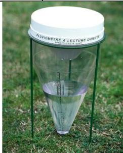
Cet appareil est un **pluviomètre** : il sert à mesurer la quantité de pluie tombée par  $\text{cm}^2$ .
