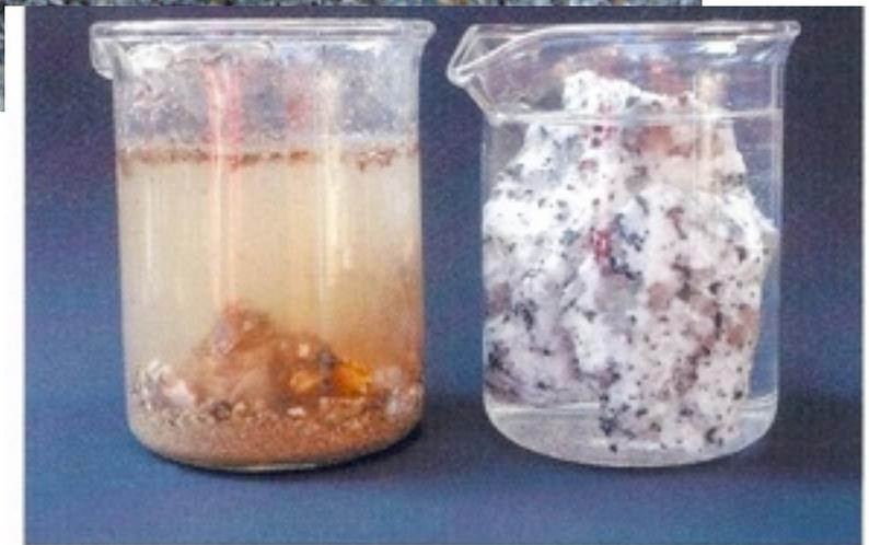
▲ Du granite altéré et du granite sain dans l'eau. Le granite altéré libère l'argile qui colore l'eau.
