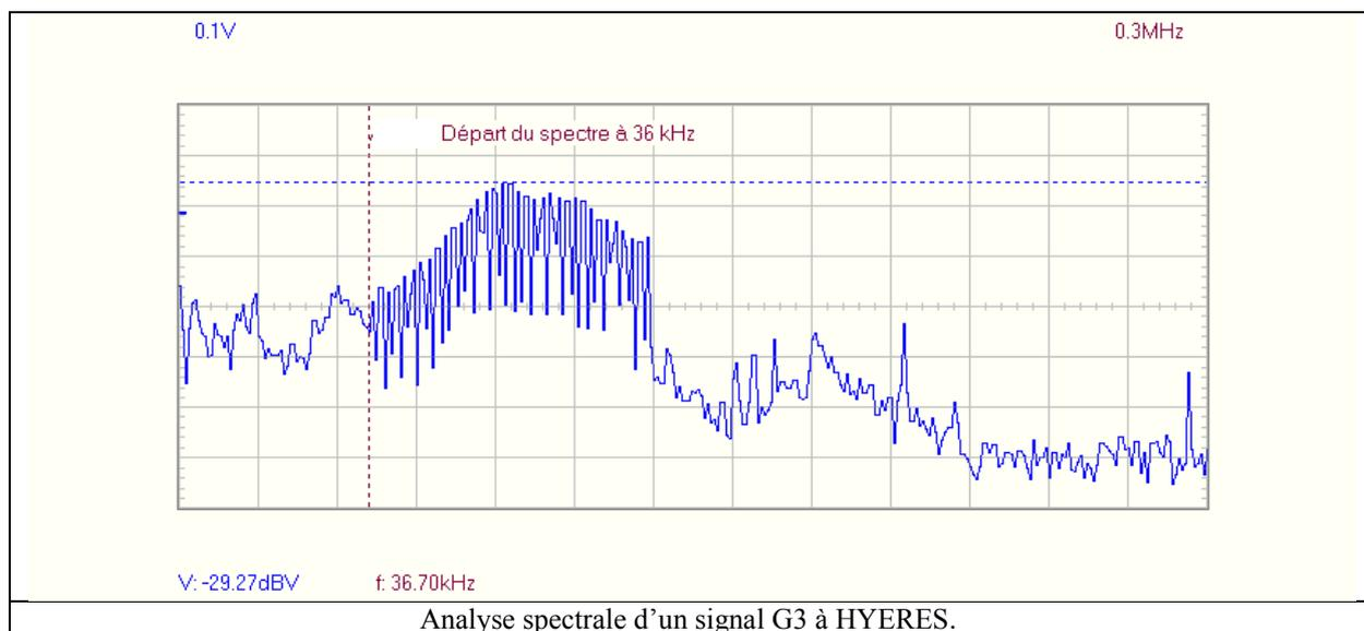
On constate la présence de 36 fréquences allant de 36 kHz à environ 90 kHz.
