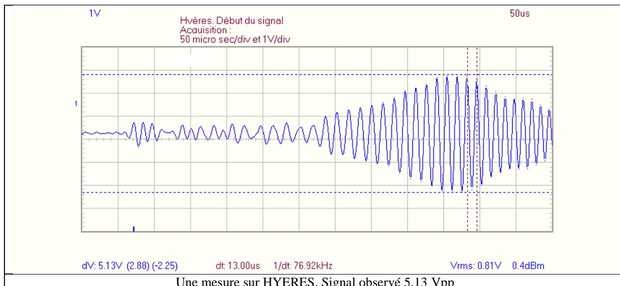
Lorsqu'on se déplace sur l'axe des temps, nous pouvons vérifier que l'amplitude et la fréquence du signal évoluent, ce qui caractérise un signal obtenu en faisant la somme de plusieurs fréquences
