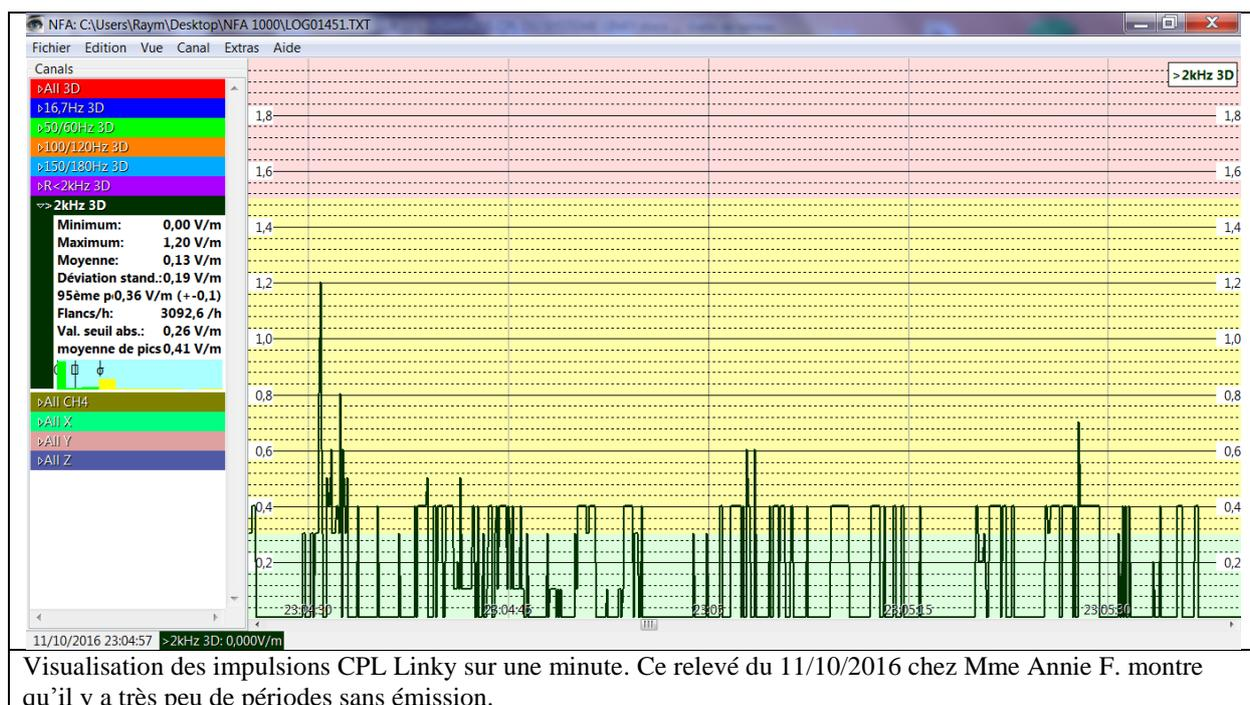
L'enregistrement d'une durée de 6 heures et 48 minutes (du 1/10/2016 à 20H25 jusqu'au 12/10/2016 à 3H13) montre la répétition incessante des trains d'ondes circulant sur le réseau domestique.
