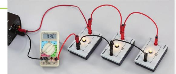
Fig. 1 : Mesure dans un circuit comportant trois lampes en dérivation.
