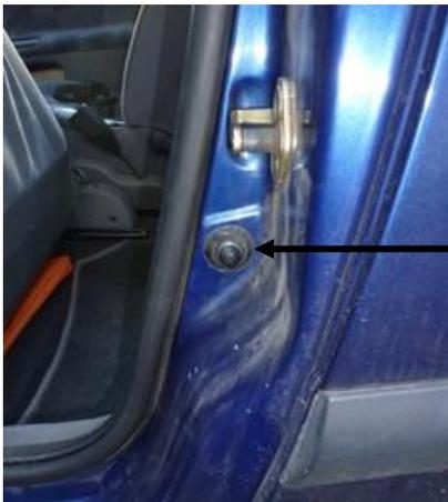
exemple de position de l'interrupteur automobile
