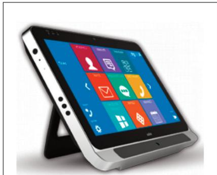
Tellus I5 équipé d'une commande oculaire intégrée Eye Tech et du logiciel Mind Express 4
