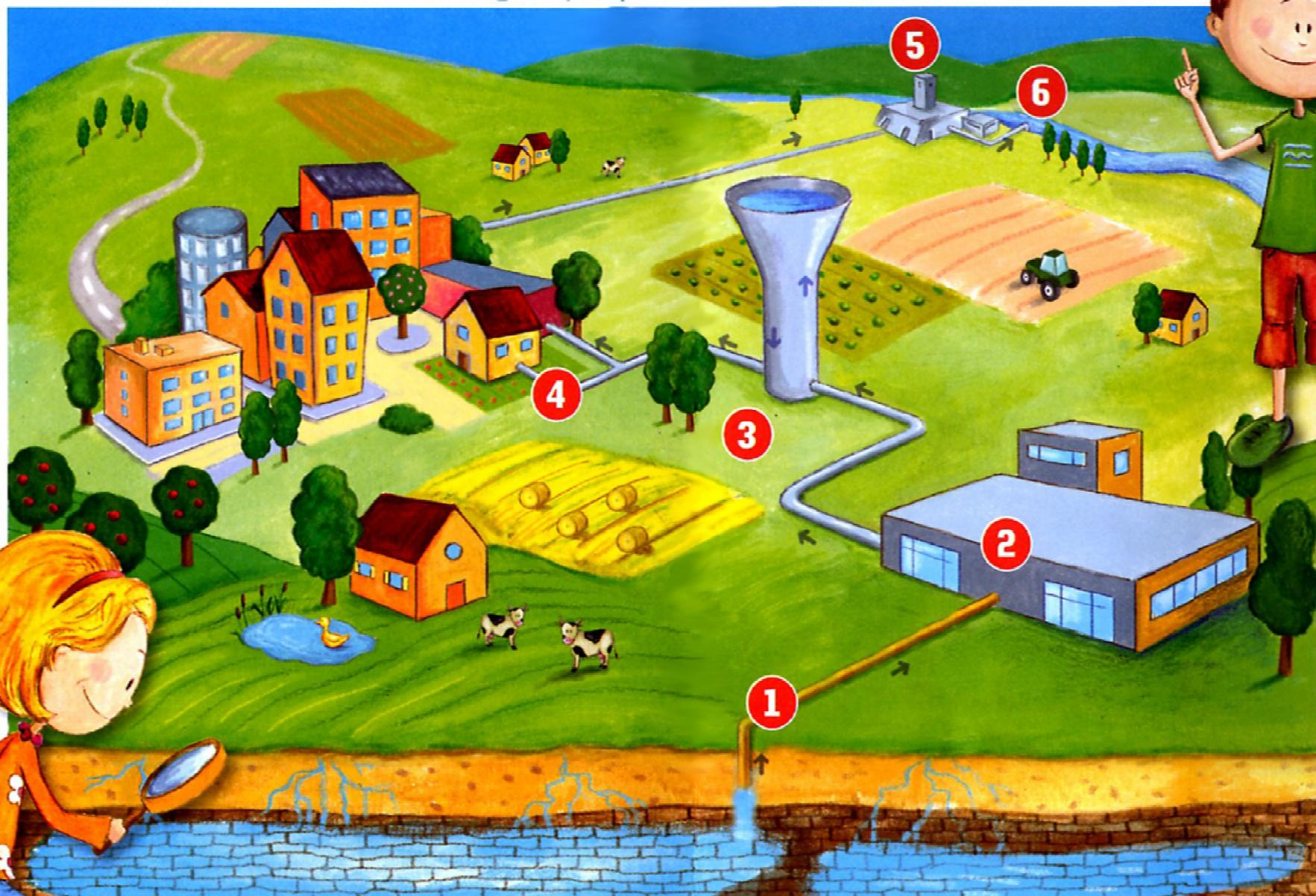
Sur la piste du cycle de l'eau ! 1 L'eau est pompée dans les nappes phréatiques. 2 Elle est ensuite traitée dans une usine pour devenir potable. 3 L'eau est stockée dans les réservoirs et les châteaux d'eau. 4 Elle arrive jusqu'à ta maison par des canalisations souterraines. 5 L'eau est nettoyée dans une station d'épuration. 6 Elle est évacuée vers la Seine.
