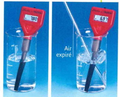
Fig. 4 : Évolution du pH en présence de dioxyde de carbone.
