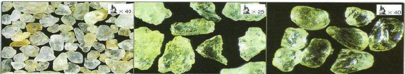
Figure. a : Aspect des grains de sable non transportés ou ayant subi un faible transport : grains **Non Usés (NU)**.
