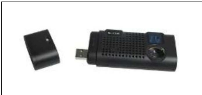
La clé USB LiFi qui permet aux PC ou aux tablettes de se connecter en LiFi.
