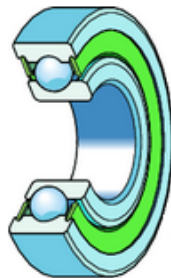
Schéma d'un roulement à billes écorché
