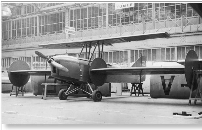
Etudié dans les années 30/34 par MM. Chappelaine et Desgrandschamps, l'Aeroogyre devait résoudre le problème de l'atterrissage à très faible vitesse. Pour ce, il est fait appel à l'effet de rotor produit par une aile que l'on laisse tourner librement autour de son axe longitudinal.
