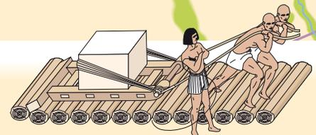
Pour transporter les blocs de pierre du canal au chantier, les Égyptiens utilisent des traîneaux qui glissent sur des rondins ou de l'**argile**. Il faut 16 hommes pour tirer un bloc de 3 tonnes, plus un chef d'équipe, des porteurs d'eau pour détremper le sol, et des caleurs. Pour les pièces plus lourdes, les équipages peuvent atteindre jusqu'à 1 000 hommes.
