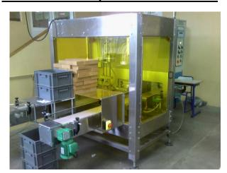
Cette encaisseuse multiformats fonctionne dans un atelier de production / conditionnement sous le contrôle d'un opérateur.
